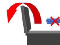
ment en raison du changement de centre de gravité. Par conséquent, lors de l'ouverture du couvercle, maintenez le boîtier en position horizontale avec l'aide d'une deuxième personne jusqu'à ce que l'installation soit terminée.
