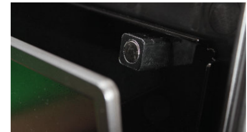
(Bild 23) Monitor vom Magnethalter gelöst
