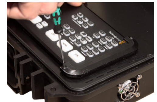
(Bild 14) ATEM Mini mit C-Spannern verschrauben
