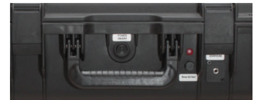
(Bild 21) LED & Sicherung an der Frontseite eines Case für ATEM Extreme
