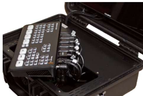
(Bild 12) Kabel am ATEM Mini einstecken
