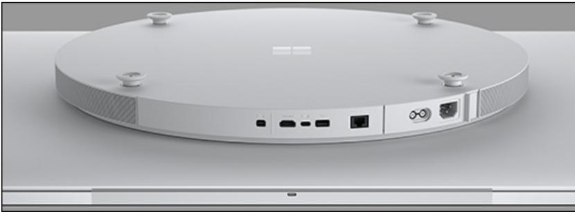
Figura 3. View del cartucho de cálculo en la parte inferior de Surface Hub 2S 50".
