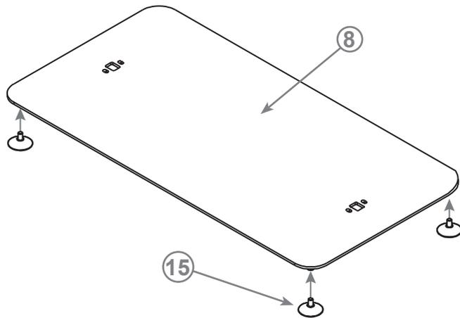
Montieren Sie zunächst die 4 einstellbaren Standfüße (15) unterhalb der Bodenplatte (8).
