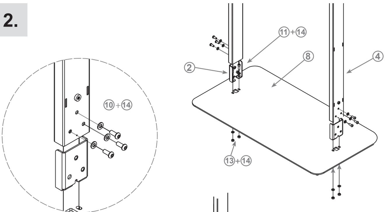
Verschrauben Sie nun die Verbindungsanker (2) sowie den unteren Teil der Tragsäulen (4) mit der Bodenplatte (8), verwenden Sie M8x20-Schrauben (10), M8x25 (11), Unterlegscheiben (14) und Schraubmutter (13).
