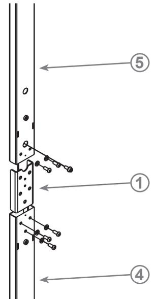
Verbinden Sie, mit Hilfe des Verbindungsankers (1) den oberen Teil der Tragsäule (5) mit dem bereits montierten unteren Teilstück (4), verwenden Sie M8x20-Schrauben (10) und Unterlegscheiben (14).
