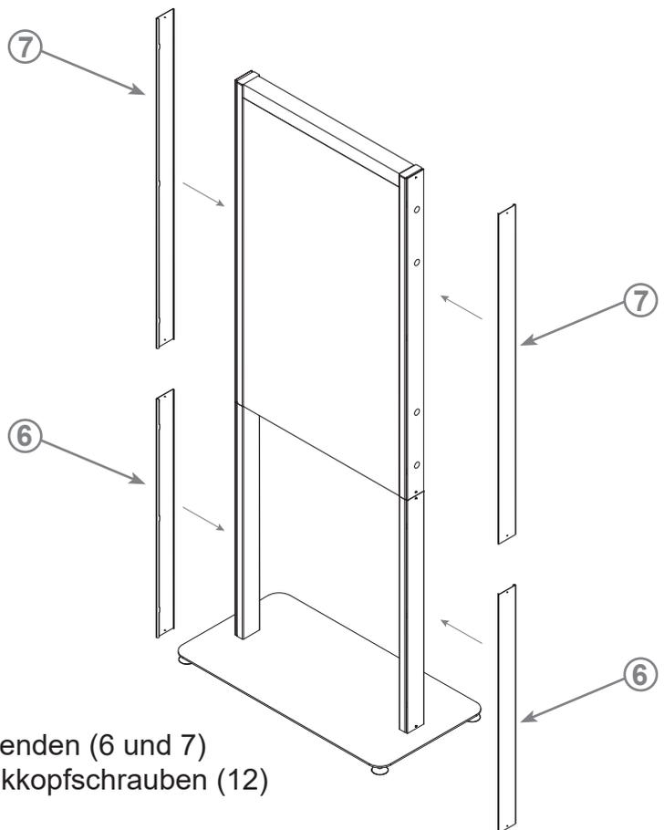
Setzen Sie die magnetischen, seitlichen Blenden (6 und 7) an die Tragsäulen. Verwenden Sie die Senkkopfschrauben (12) falls eine stärkere Fixierung notwendig ist.
