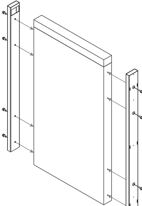
Verschrauben Sie nun den OMN-D-Screen in der Halterung, verwenden Sie zur Fixierung die M8x18-Schrauben (9).
